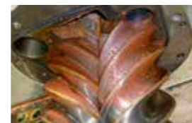
VORHANDENSEIN VON FEUCHTIGKEIT Feuchtigkeit im Öl verkürzt die Lebensdauer der Rollenlager, sie kann zu Korrosion und schweren Schäden führen
