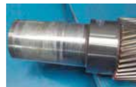
VERSCHEISS DER KOMPONENTEN Hoher Lagerverschleiß, der zum Ausfall des Verdichters führt
