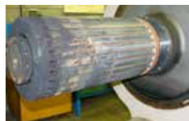
HOHER SÄUREGEHALT DES ÖLS Korrosion an den Motorwicklungen mit der Folge eines Durchbrennens des Motors
