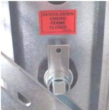
**Illustration 131** : Position fermée, caractérisée par un indicateur de position de tôle
