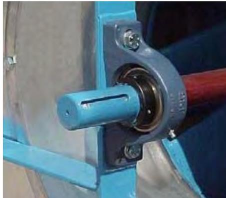
**Illustration 207** : Roulement de ventilateur avec graisseur (exemple Comefri NTHZ)
