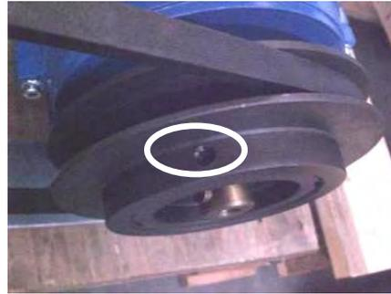
**Illustration 205** : Position des vis à six pans sur les poulies variables
