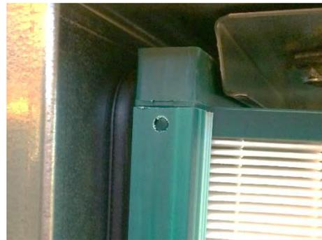
**Illustration 146** : vérifiez si le filtre repose contre le joint d'étanchéité
