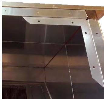
**Illustration 58** : Angle de raccordement
