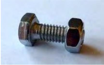
Illustration 62 : Boulon hexagonal avec écrou M6x16
