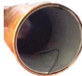
**Illustration 157** : tuyau en cuivre avec anneau de renfort inséré
