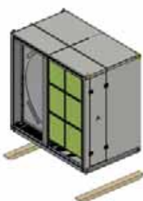
Schritt 4: 2 Holzteile entfernen
