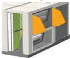
Abbildung 15 - Montageschritte für Frischlufthaube
