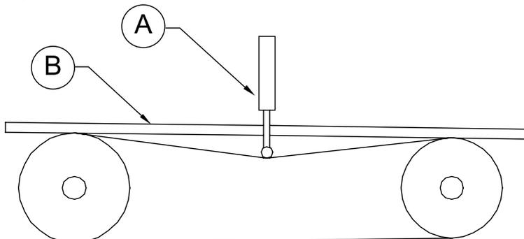
**ATTENTION !** Une courroie trop tendue risque d'endommager le moteur et les roulements du ventilateur. Une courroie détendue s'use prématurément et fournit des prestations médiocres, car elle a tendance à patiner sur les poulies.
