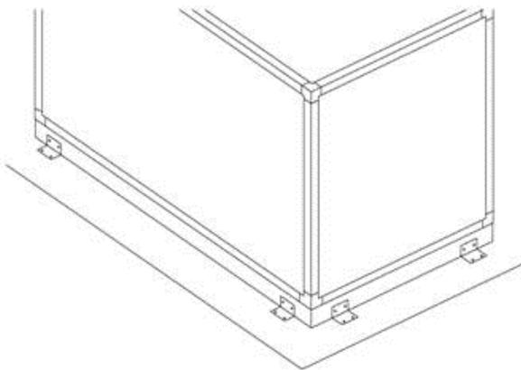
Retirez les supports de fixation anti-vibrations avant la mise en marche de la centrale. Leur rôle se limite à protéger la centrale pendant le transport.
