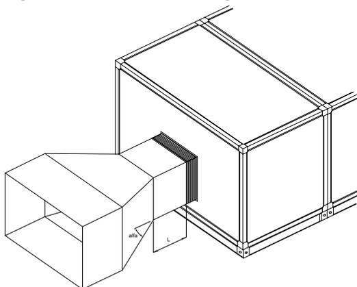
En général, la longueur « L » de la première section de gaine doit être au moins une fois et demie supérieure au diamètre du ventilateur. L'angle 'a' de la gaine de transition doit être inférieur à 30° et il doit faire en sorte d'éviter une réduction de la section juste après le point de raccordement de la gaine à la centrale (voir figure 9).
