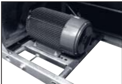
LRT Ventilatormotor, montiert
