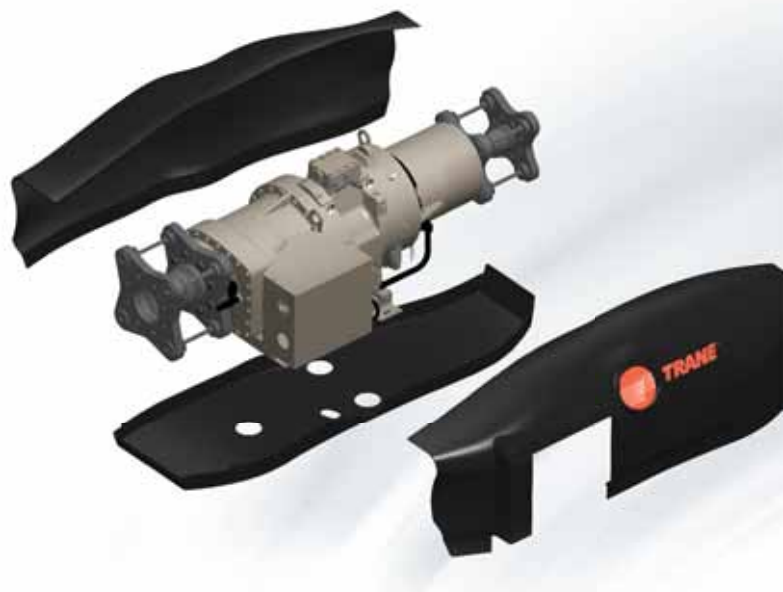
Le boîtier de compresseur breveté et les soufflets métalliques absorbent les vibrations provoquées par le fonctionnement normal du compresseur.
